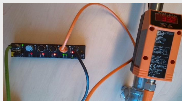
Abb. 13: IO-Link-Durchflussmesser an ein IO-Link-Mastermodul angeschlossen
